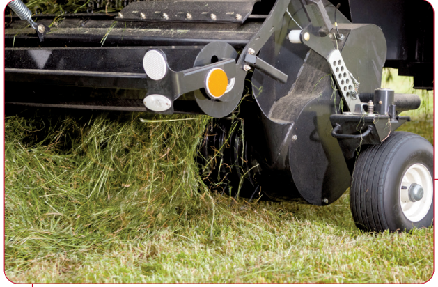
'W' şeklinde yüksek performanslı besleme rotörü, 20 adet kıyıcı bıçak ile küçük kıyma boyu sağlayabilen haşbay düzeni. DropFloor™ sistemi ile kabinden inmeden hidrolik olarak rotor sıkışmalarını açabilme. Tarla sonu dönüşlerde kolaylık sağlayan Pick-Up tekeri.
